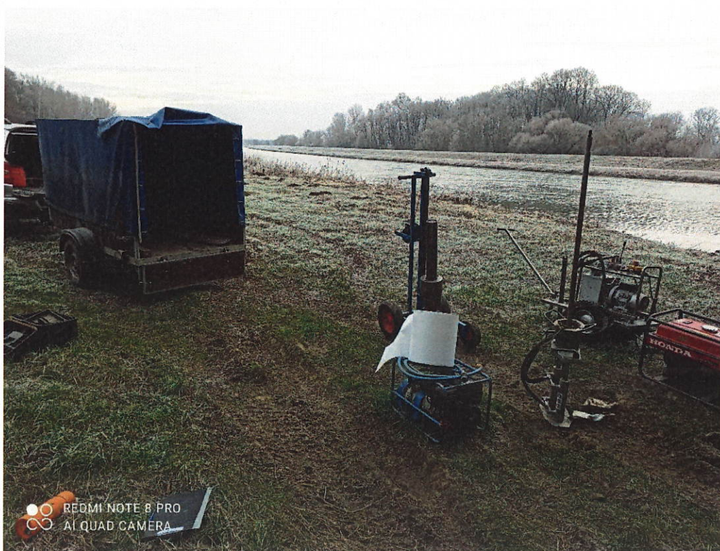
Geologické práce – realizácia Dynamickej penetrácie
