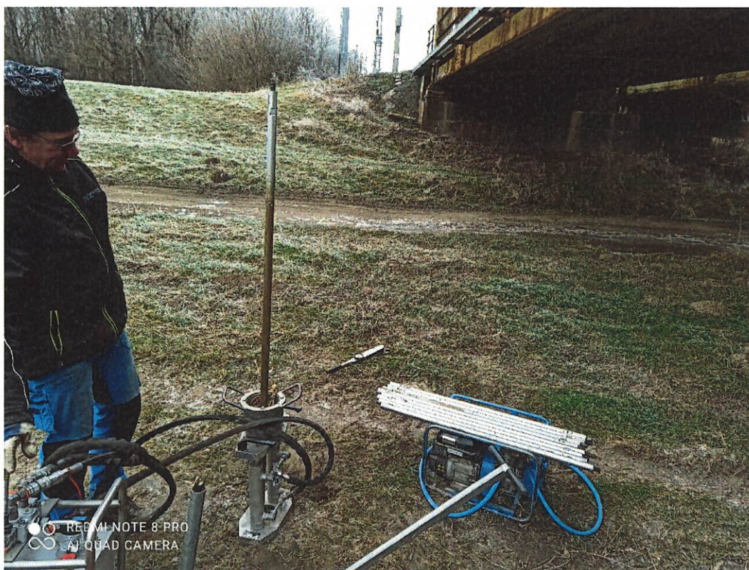
Geologické práce – realizácia Dynamickej penetrácie
