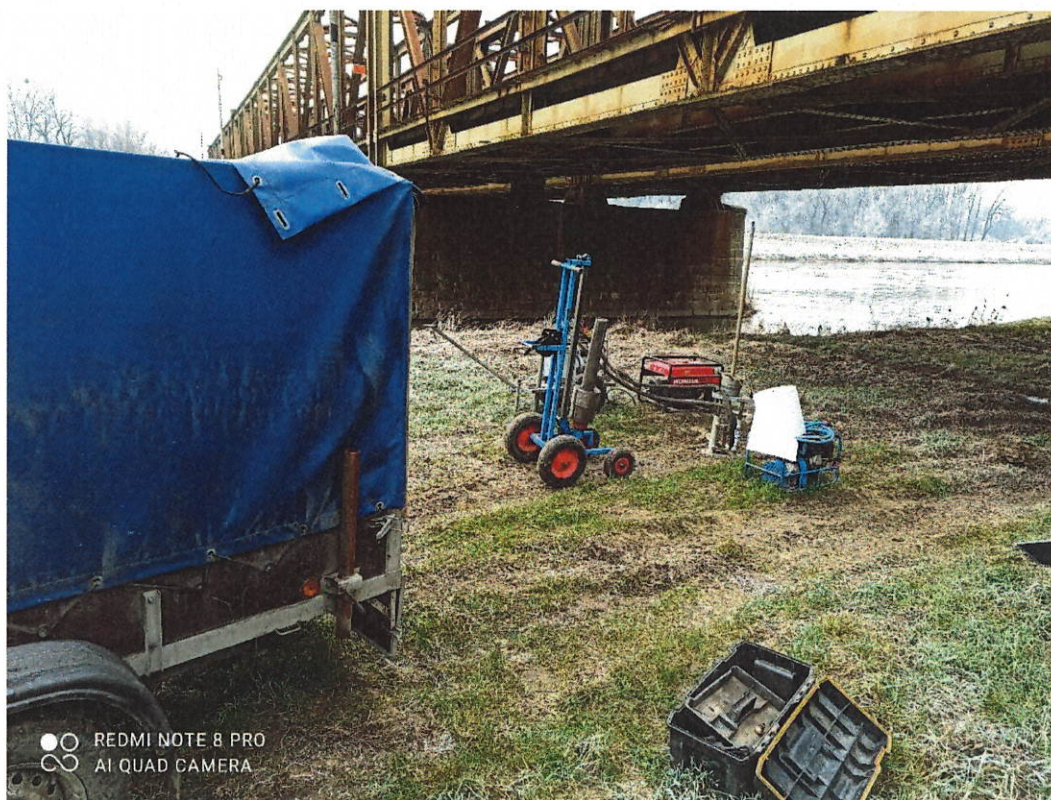
Geologické práce – realizácia Dynamickej penetrácie
