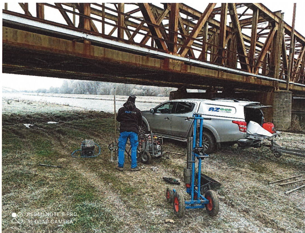
Geologické práce – realizácia Dynamickej penetrácie
